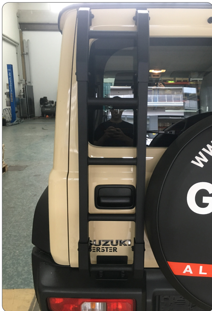
Abb. 10: Montierte Leiter / mounted ladder
